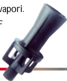
Il sistema di agitazione dei bagni EDUCTOR si ottiene tramite l'utilizzo di una pompa ed una serie di ugelli VENTURI adeguatamente piazzati all'interno della vasca. Esso permette, utilizzando una pompa relativamente piccola, di creare una vigorosa agitazione intorno ai pezzi da trattare. Ogni VENTURI incrementa 5 volte l'effetto della portata di ingresso della pompa per ogni singolo ugello.
