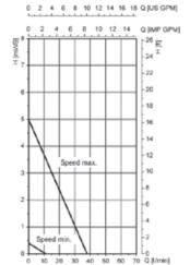
Speed min. 5.000 rpm, speed max. 15.000 rpm
